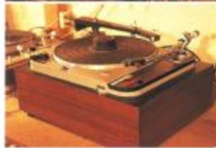
左/メインで使い続けているターンテーブルはDENON製で、1960年頃に放送局用として使われていたものをただ同然で引き取り、自ら修理したもの。トルクが強く回転にぶれがないため、安定した性能を発揮するという。
